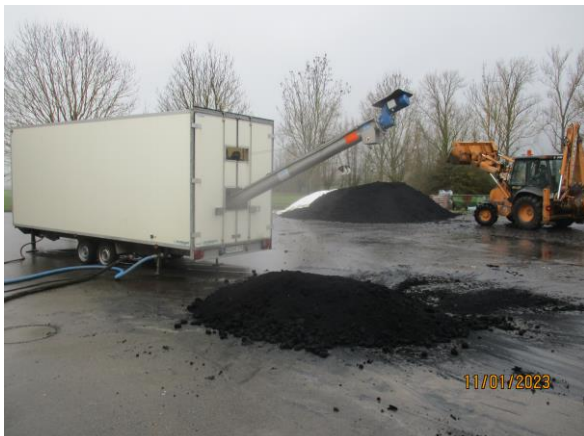
Mobile Schlammpresse auf Pkw-Anhänger:
